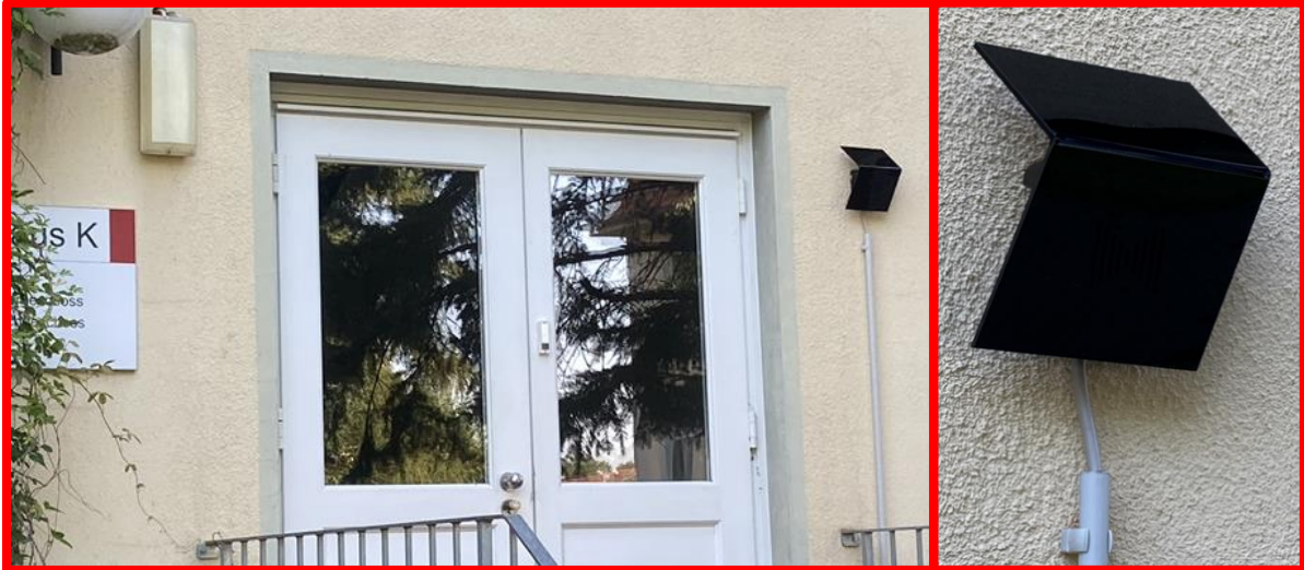
Foto: Haus K Hintereingang. ' Rechtsseitig neben der Tür ist ein LOC.id-Gerät mit integrierten Lautsprecher montiert.
